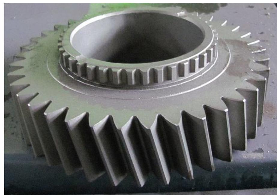
**Фото 2.** Шестерня 2-ой передачи вторичного вала 1509.1701127
