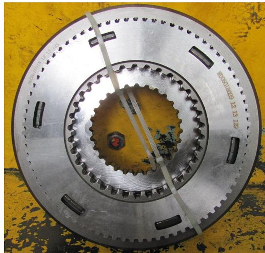
Фото 6. Синхронизатор 4-5 передачи RC30316002 (8.9322)
