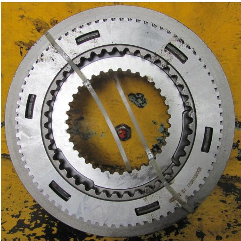
Фото 5. Синхронизатор 2-3 передачи RC30316001 (8.9321)
